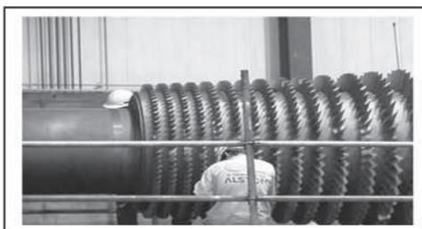
Fig 1. Empalhetamento do rotor do compressor.
