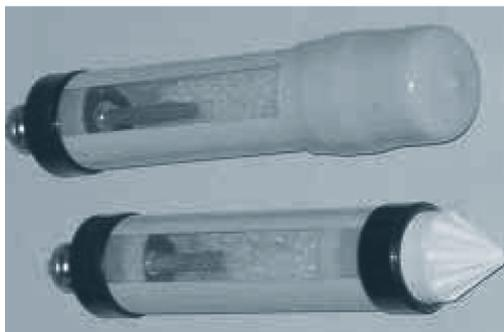
Figura 25. Electrodo no polarizables de cobre sulfato de cobre.
