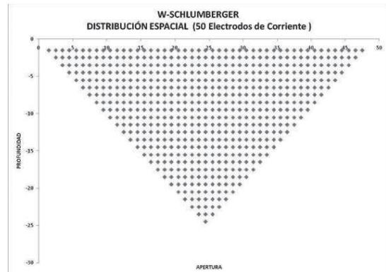
Figura 18. Distribución bidimensional de puntos a los cuales se les obtendrá el valor de resistividad.
